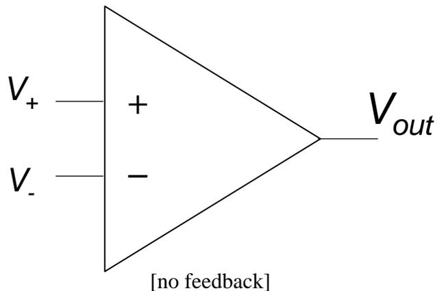
**Op-amp equation:**  $V_{out} = Gain \times (V_+ - V_-)$
