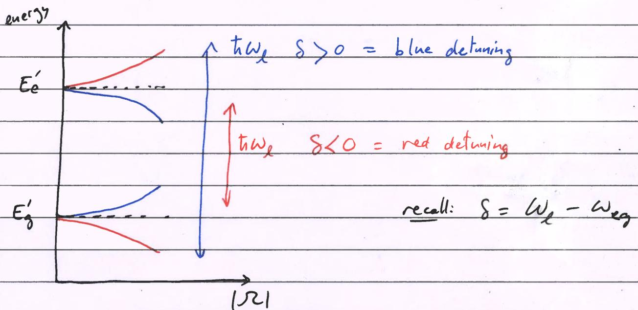
For  $H_{\text{int}} = e \vec{E}_0 \cdot \vec{R} \cos(\omega_e t) \rightarrow$  AC Stark shift
